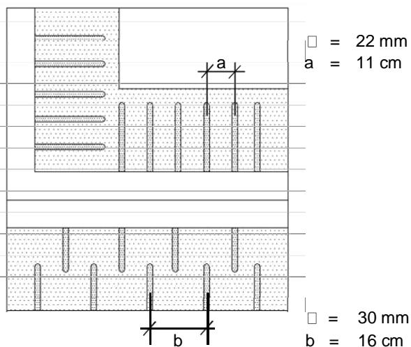
Bušenje se izvodi jednostrano, samo u specijalnim slučajevima se koristi dvostrano bušenje, kod kamenih zidnih struktura u kojima je došlo do pukotina nepravilnog oblika.
